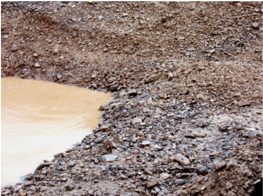
Abb. 7: Das für die Aufschüttung im Baggersee vorgesehene kiesige Material wird im Bereich des Grundwasserhorizontes ausgebaggert und weist nur einen geringen Feinsedimentanteil auf.
