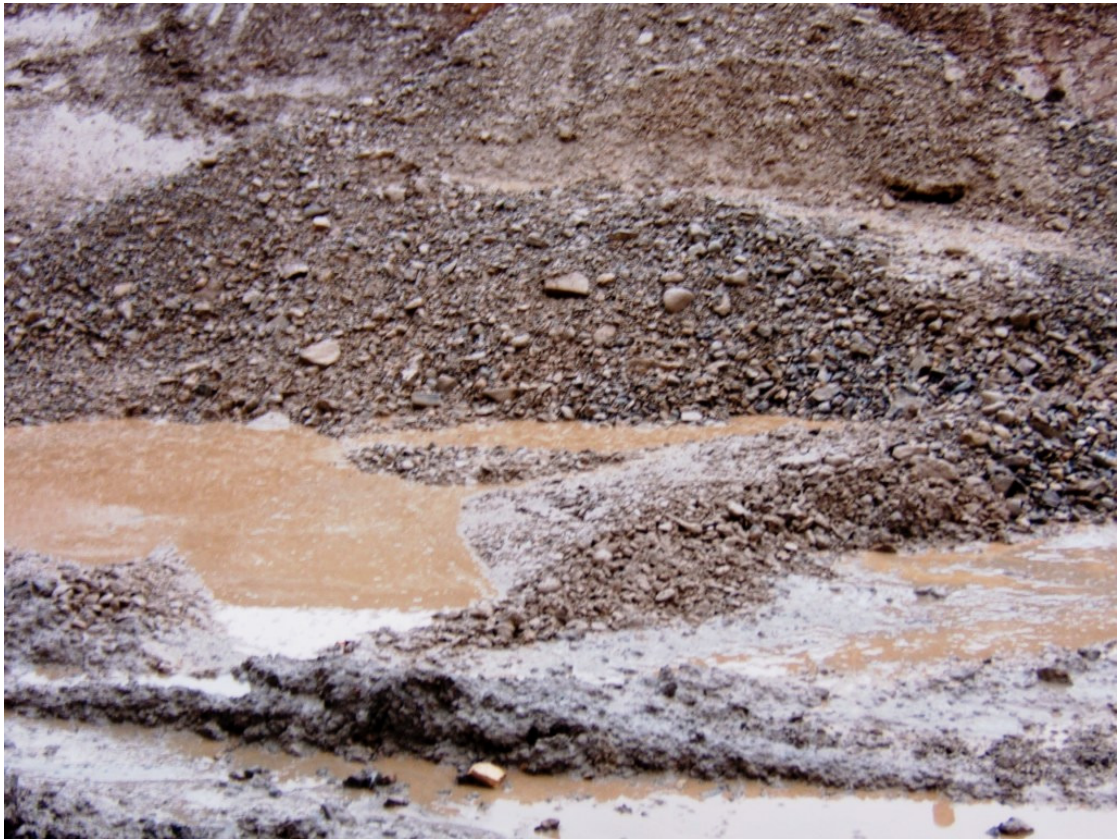
Abb. 8: Die Korngröße des vorgesehenen Schüttmaterials bewegt sich fast ausschließlich im Bereich der Kiesfraktionen mit einem deutlichen Anteil der Steinfraction bis ca. 10 cm Durchmesser.
